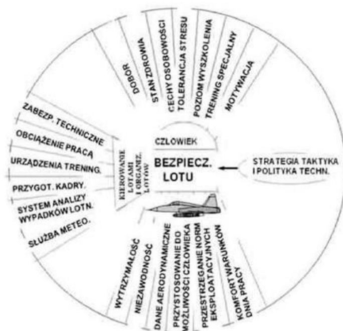
Rysunek 6. Model systemowego ujęcia problemów bezpieczeństwa lotów wg Łomowa i Płatonowa. Źródło: E. Klich, „Bezpieczeństwo lotów” 71 .
