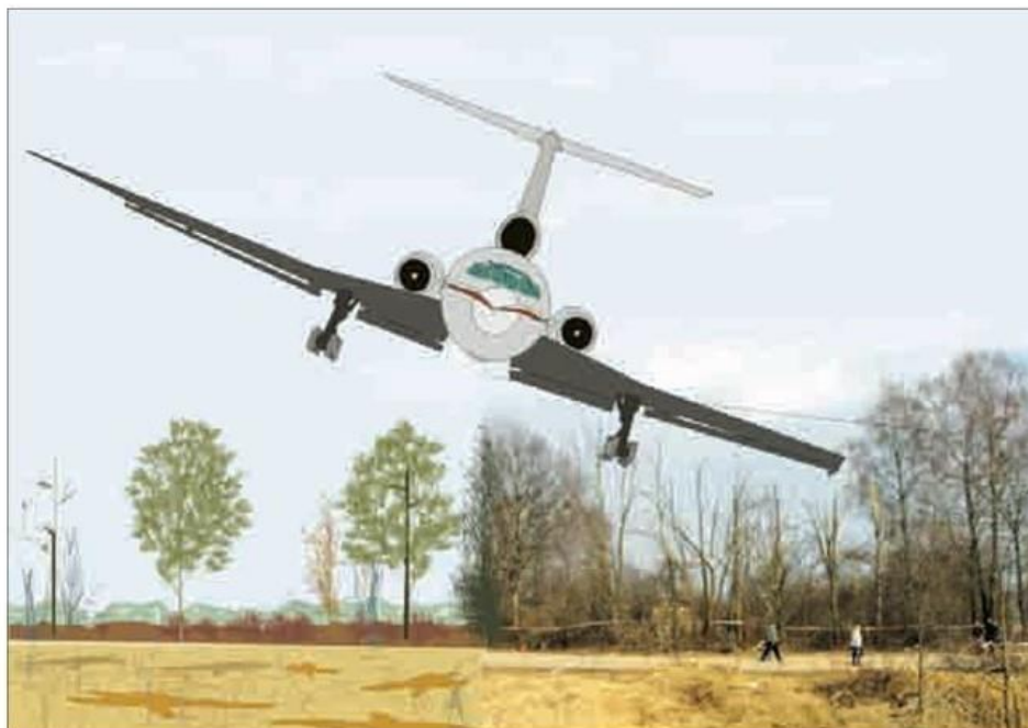
Rysunek 19. Rekonstrukcja lotu samolotu w przechyleniu około 20^\circ . Widoczne ścięte wierzchołki drzew. Widok od strony przeciwnej do kierunku nalogu. Źródło: E. Klich „Bezpieczeństwo lotów” 598 .
