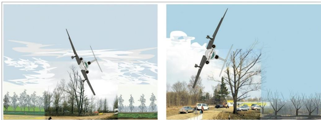
Rysunek 20. Dwie kolejne pozycje samolotu odtworzone na podstawie śladów na drzewach. Źródło: E. Klich „Bezpieczeństwo lotów” 599 .
