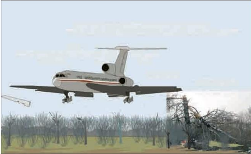
Rysunek 18. Samolot po zderzeniu z pniem brzozy o średnicy ponad 40 cm. Źródło: E. Klich „Bezpieczeństwo lotów” 597 .
