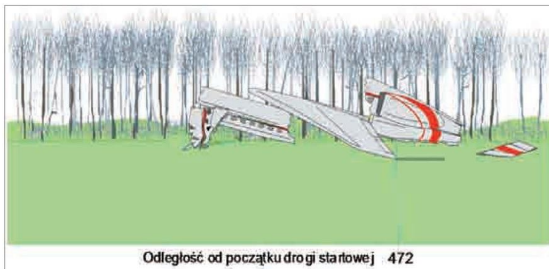
Rysunek 23. Początek niszczenia samolotu po zderzeniu z ziemią. Źródło: E. Klich „Bezpieczeństwo lotów” 603 .
